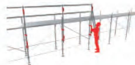
2) Quando l'operatore sale al piano superiore trova il Parapetto Provvisorio già posizionato, che gli permette di proseguire con l'allestimento del Ponteggio in Sicurezza.
