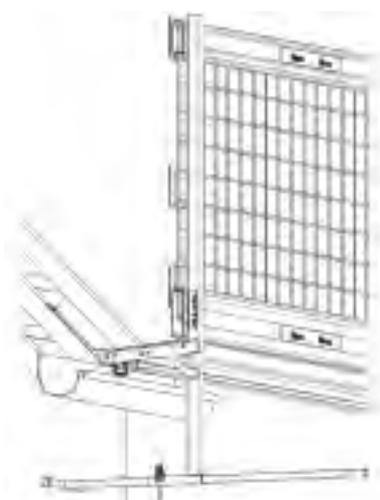
**Questo sistema è realizzato in alluminio, materiale sintetico ed acciaio. Interesse 3m.**
