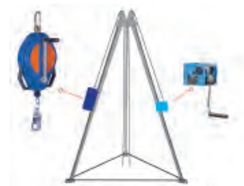
**Accesso con scala comune (non dotata di sistemi anticaduta) e movimentazione carichi materiali, profondità <15m o <25m EN 795B + EN1496B + EN360; 2006/42 CE. Carichi fino a 250 kg**
