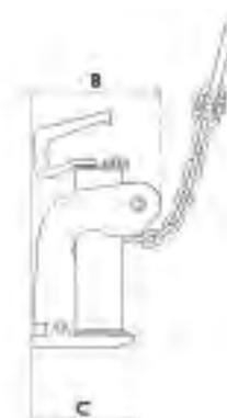
PINZE REGOLABILI PER IL SOLLEVAMENTO ORIZZONTALE DI PROFILATI METALLICI
