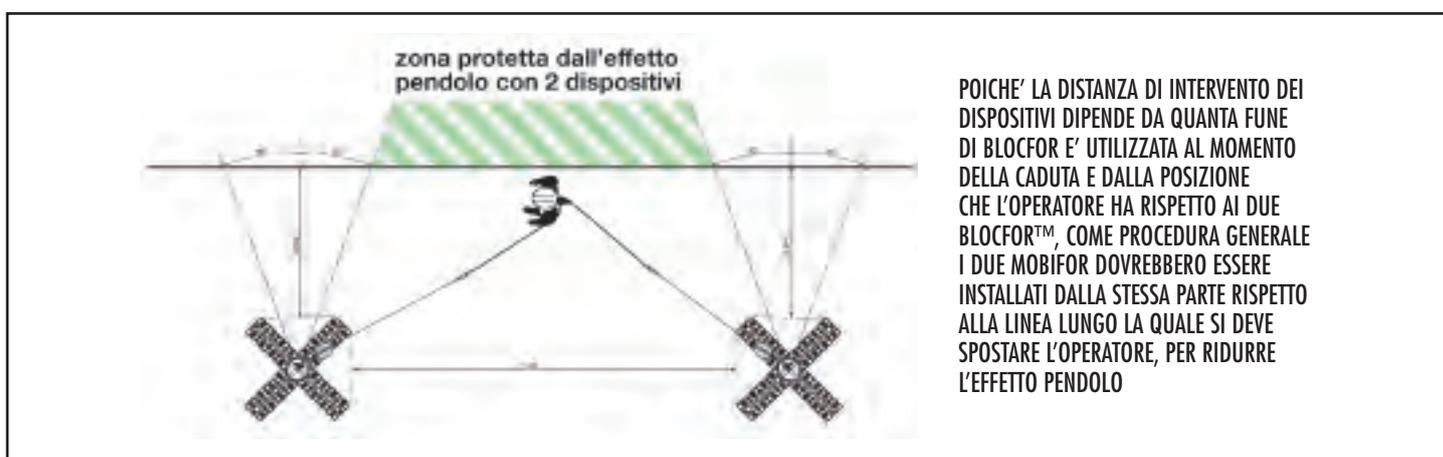
POICHE' LA DISTANZA DI INTERVENTO DEI DISPOSITIVI DIPENDE DA QUANTA FUNE DI BLOCFOR E' UTILIZZATA AL MOMENTO DELLA CADUTA E DALLA POSIZIONE CHE L'OPERATORE HA RISPETTO AI DUE BLOCFOR™, COME PROCEDURA GENERALE I DUE MOBIFOR DOVREBBERO ESSERE INSTALLATI DALLA STESSA PARTE RISPETTO ALLA LINEA LUNGO LA QUALE SI DEVE SPOSTARE L'OPERATORE, PER RIDURRE L'EFFETTO PENDOLO
