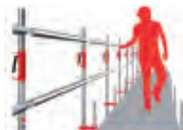
3) L'operazione prosegue allo stesso modo per i vari piani del Ponteggio. Man mano che viene posizionato il Parapetto Definitivo, l'operatore può innalzare al piano superiore le Sponde Provisorie di EuroSafe.
