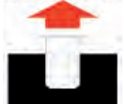
$R_{min} = 220daN$  a trazione per ogni singolo fissaggio (i fissaggi sono esclusi). La resistenza dell'ancoraggio determina la scelta del sistema di fissaggio (totalmente meccanico, meccanico + chimico, ecc) coerentemente alla struttura della copertura.
