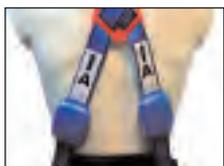
Adattatore Elastrac™: Consente il controllo dell'estensione delle bretelle dell'imbracatura a +/- 4 cm per assecondare i movimenti dell'operatore e il controllo dell'estensione a +/- 12 cm in caso di caduta\* (test effettuati con una massa di 100 kg). Più di 1 milione di cicli senza perdita di elasticità o degradazione del nastro. Adattatore infrangibile in uso normale.
